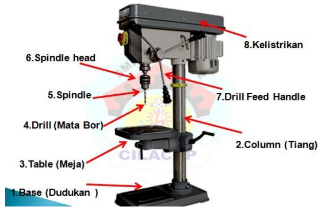
Gambar 4.26 Bagian Bagian Mesin Bor
